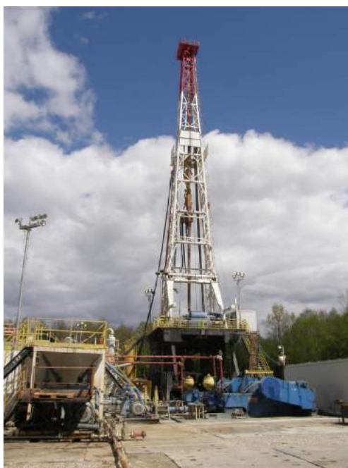
Slika 3. Primjer bušačkog postrojenje (National 402)
